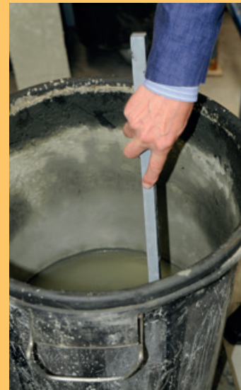
Muestra del fluido denso preparado como lastre para turbinas eólicas.
