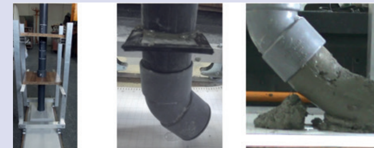
Impresión 3d con hormigón.
