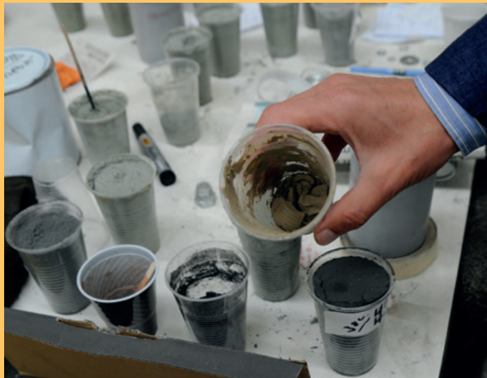
Muestra del fluido denso preparado como lastre para turbinas eólicas.
